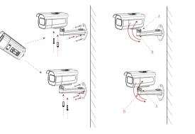
с помощью винтов. Сам кронштейн может быть предварительно саморезов, либо прикрепите камеру ключом после в сборе с кронштейном к стене с помощью саморезов.
