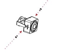
Отрегулируйте угол установки, затяните винты, установка завершена.
